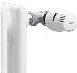
Cet organe permet de limiter et de maintenir la température d'une zone, d'une pièce. Le robinet, équipé d'une tête thermostatique, régule (en augmentant ou en diminuant) le débit d'eau distribué au radiateur afin de maintenir constante la température de la pièce. Une température de consigne est imposée à l'aide des numéros présents sur la poignée de réglage de la tête thermostatique.
